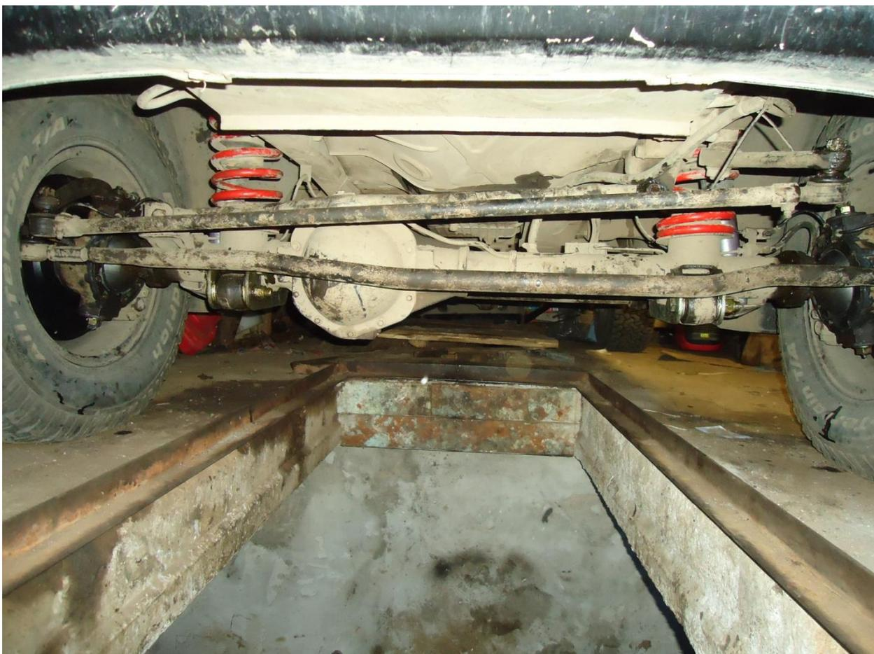
Примечание: окончательная затяжка болтов крепления продольных и поперечной тяги, а так же крепления амортизаторов осуществляется после того, как автомобиль будет опущен на колеса (на относительно ровной площадке).
