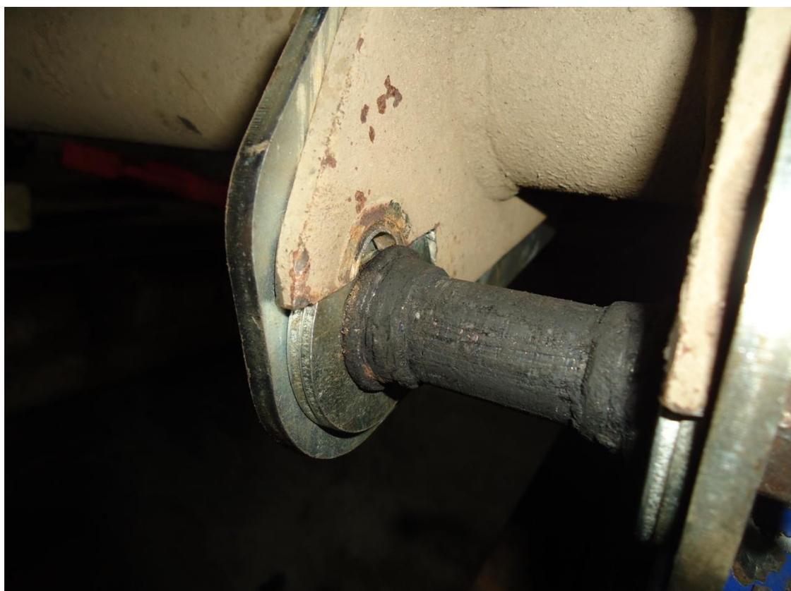
Дополнительные отверстия в кронштейне сверлятся по месту с установленными платами (Сверло на 16 м).
