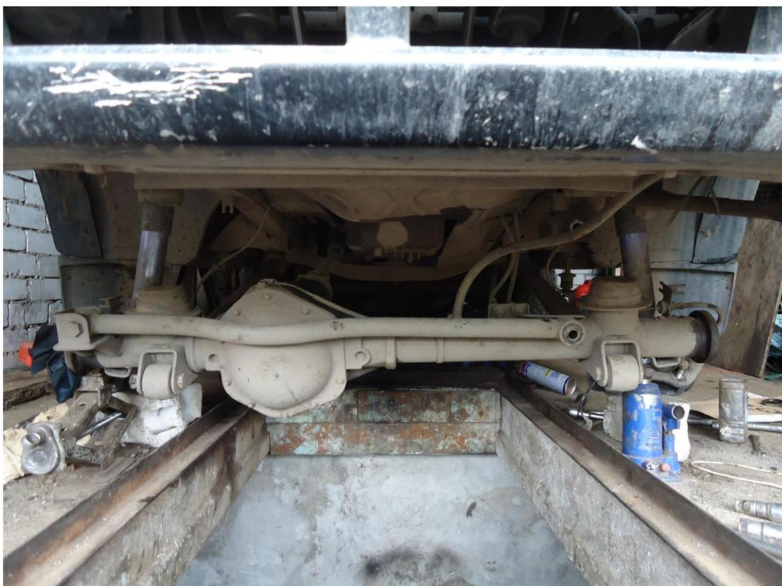
Теперь необходимо снять одну из продольных тяг и доработать болгаркой, в соответствии с чертежом, кронштейн тяги на мосту.
