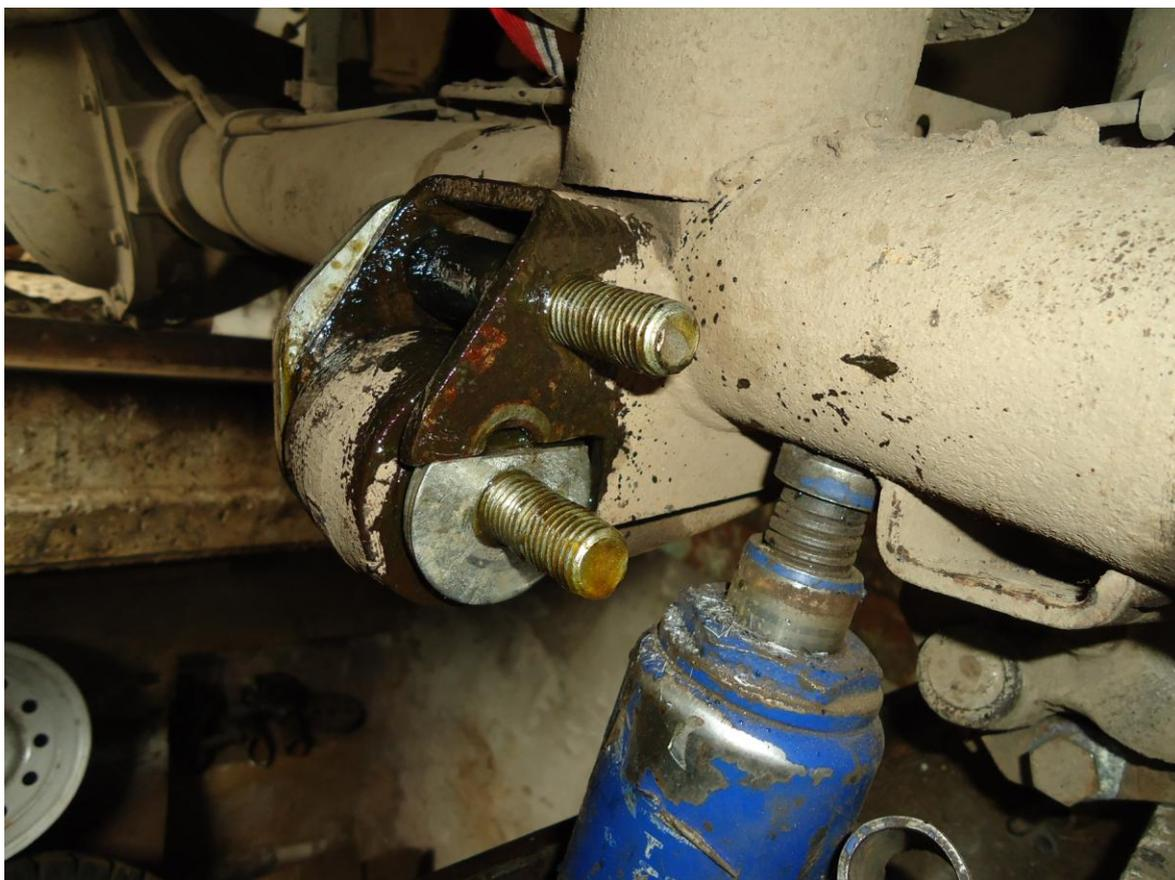
Остается только надеть вторую плату, наживить гайки (полная затяжка производится, когда автомобиль будет стоять на колесах) и можно переходить ко второму кронштейну.
