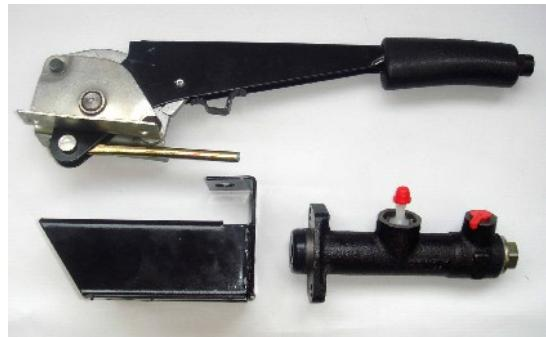
2. Установить на кронштейн (6) главный цилиндр (12) закрепив его двумя болтами M6x25(25) и гайками M6 (26) (*Сильно не затягивать, окончательная затяжка гаек после позиционирования и установки штока в цилиндр.*)
