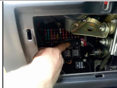
Подключаем диагностическую вилку к разъему диагностики автомобиля и закрываем крышку блока предохранителей. Дисплей бортового компьютера при этом должен засветиться.
