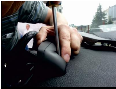
Закрепляем БК на панели приборов винтами из комплекта поставки.
