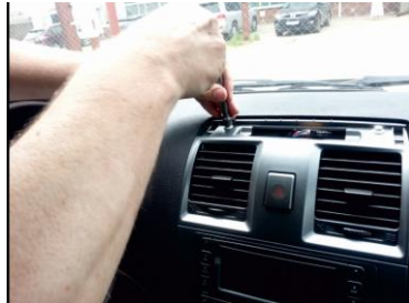
Снимаем блок подогрева сидений и переключателя топливных баков
