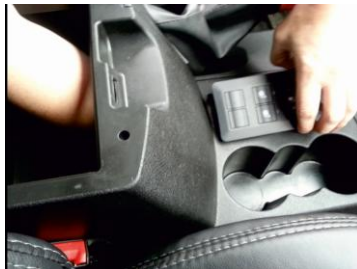
Снимаем блок подогрева сидений и переключателя топливных баков
