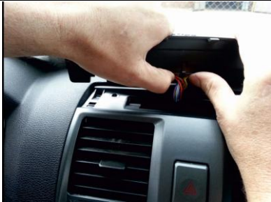
Подключаем разъем монтажного жгута к разъему бортового компьютера.
